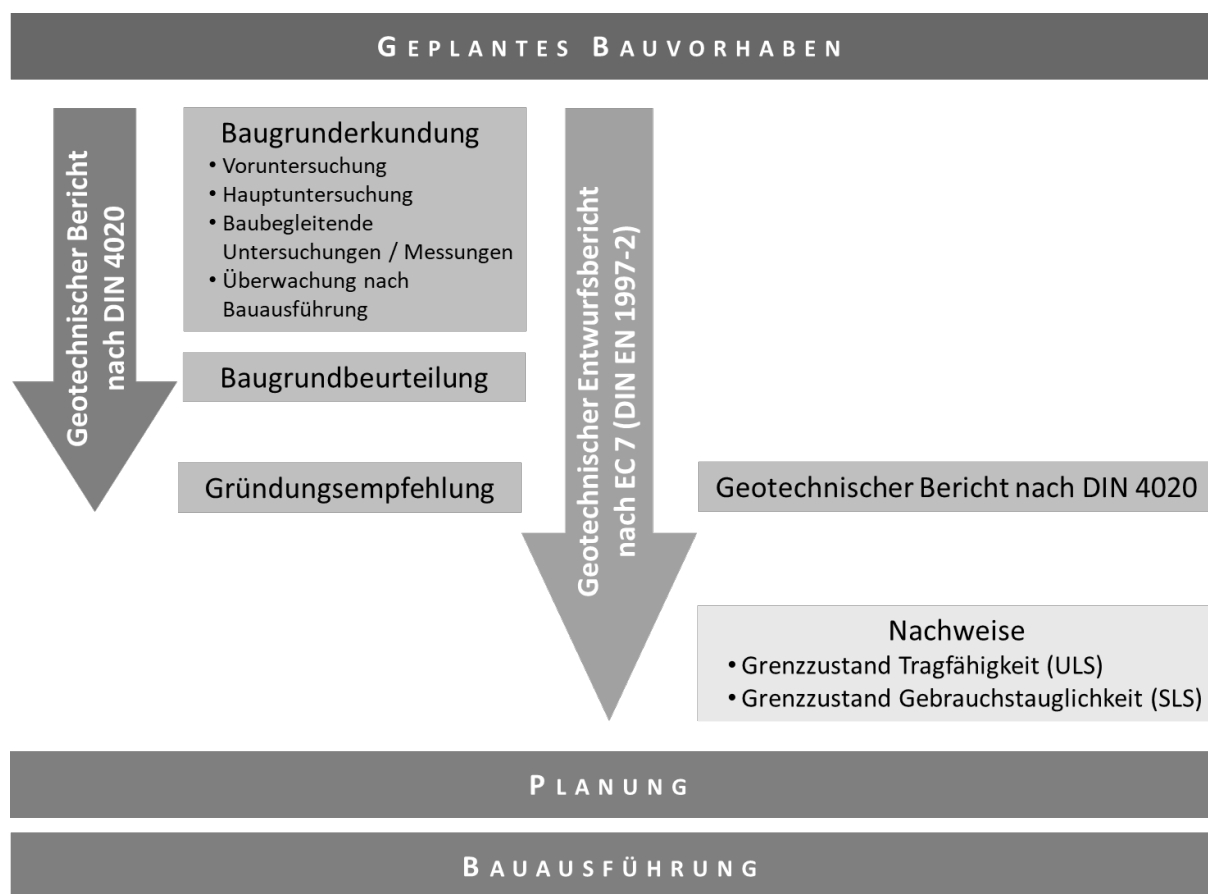
Abb. A-07: Einordnung des „Geotechnischen Berichts/Entwurfsberichts“ in den Bauprozess
