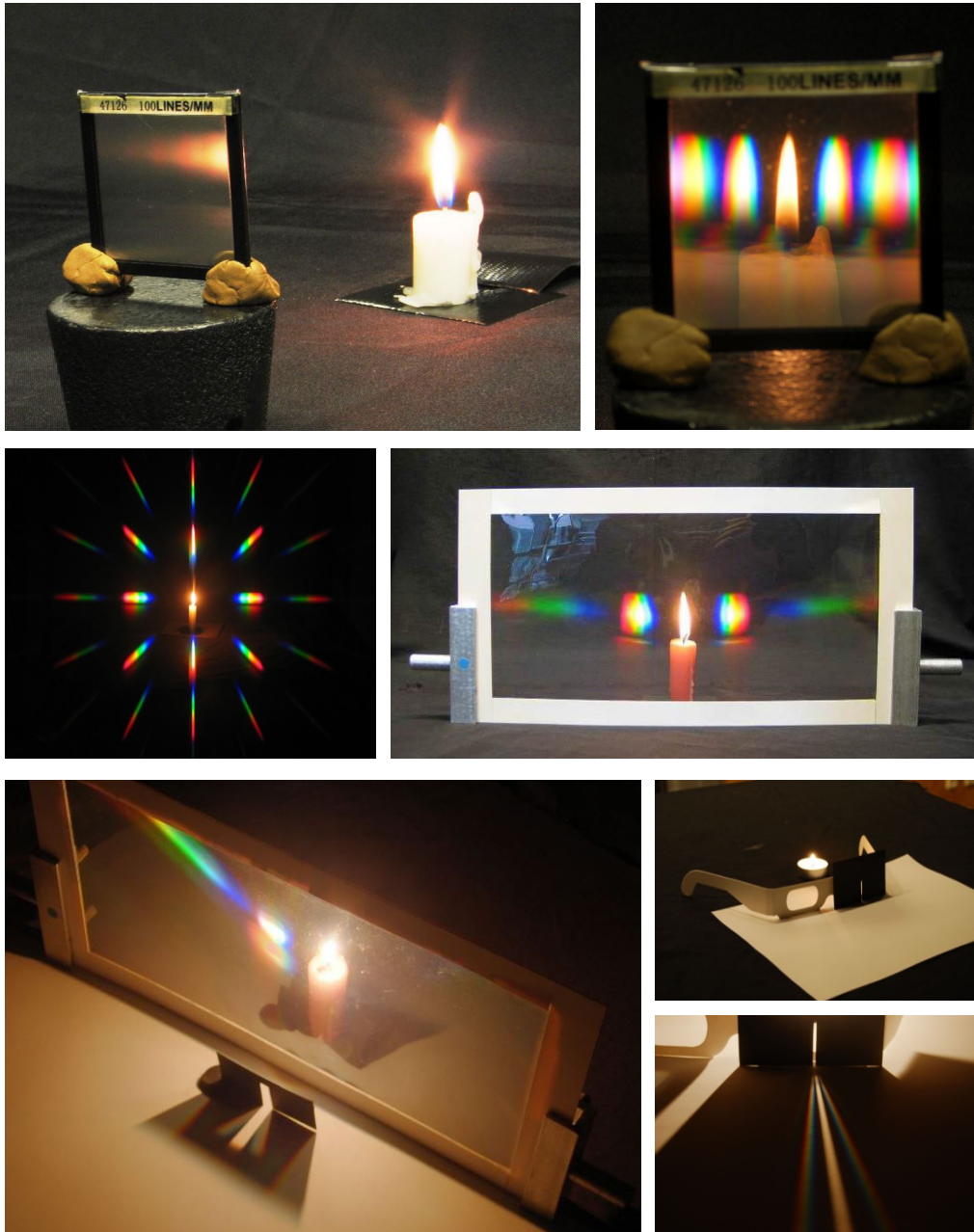
Abbildung 14.4: „Wechsel in die eingebundene Perspektive“ – oben: Blick durch das Strichgitter auf eine brennende Kerze. Es zeigt sich eine Reihe farbiger Nebenbilder der Kerze, die den Beugungsmustern aus (1) und (6) ähnelt; Mitte: Blicke auf eine brennende Kerze durch eine Kreuzgitterbrille (ca. 200 Linien je mm) und durch ein großes Strichgitter (ca. 15 x 30 cm, ca. 1000 Linien je mm); unten: vervielfachte, farbig gesäumte Schatten an Gittern (am großen Strichgitter und an der Kreuzgitterbrille).
