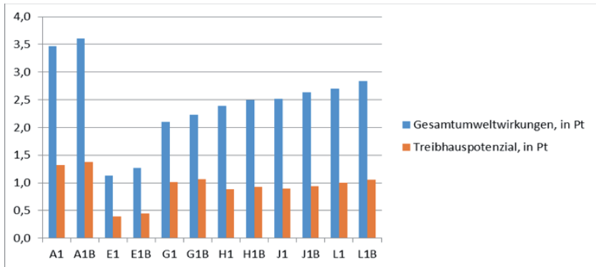
Abbildung 4-8: Vergleich Gesamtumweltwirkungen in Pt und Treibhauspotenzial in Pt, gesamter Lebenszyklus (Eigene Darstellung)
